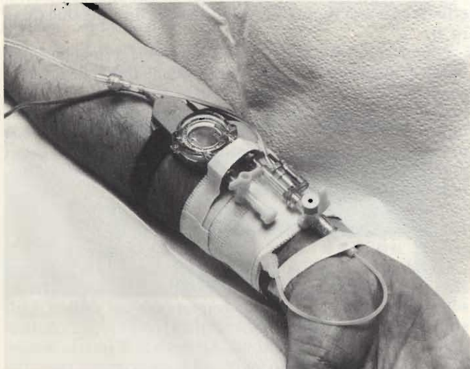
Fig. 1 - Rilevatore capacitivo della pressione arteriosa impiegato per il controllo continuativo di un paziente (specialmente nei reparti di terapia intensiva).
